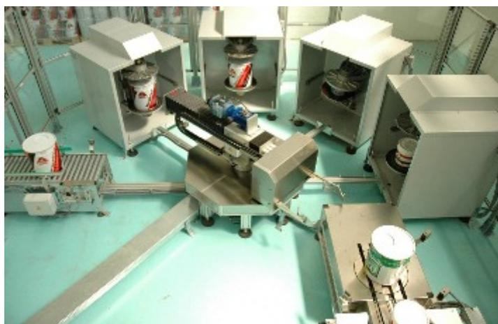
ミキシングサイクル(工程)は、製造の“ボトルネック”である可能性が高く、ゆえに、速度が速く、効率的で、多様なシフト(製造工程)で問題なく動作する攪拌装置が必要です。ミキシングステーションは“自動調色ライン”のひとつのモジュールです。どのような調色機器とも融合できます。ロボットが所定の位置で調色された異なるサイズや形の缶をピックアップします。
