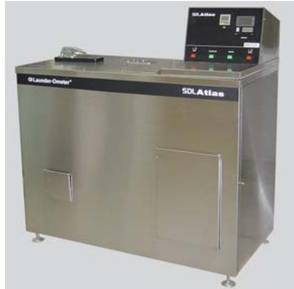
Launder - Ometer は、色落ち、汚染、ドライクリーニング、退色性、収縮率のテストや、温度を 95 まであげて行なうテストなどにも用いられます。ステンスローターには、4つの側面のそれぞれに、5つの試験容器があり、(トータル20個)毎分 40(±2)回転します。容器は、適切なテスト溶液によって、予熱されます。ステンレスボールによって、回転中にかき混ぜられます。容器は、ネオプレンゴムガスケット(パッキング)か、注文付属品のテフロンガスケット(パッキング)によって密閉されます。
